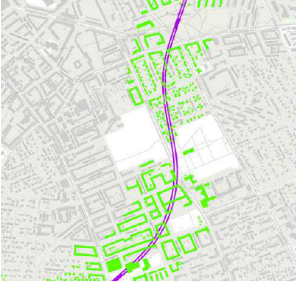
Figur B3.5 Vibrationskort for vibrationskomfort drift af M5 på strækningen Amagerbrogade Syd – Lergravsparken.
