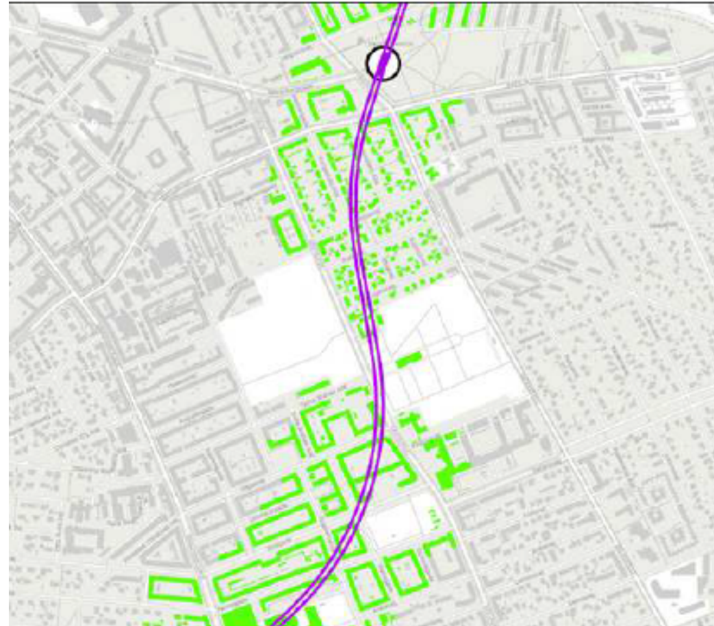
Figur B3.15 Vibrationskort for strukturlyd drift af M5 på strækningen Amagerbrogade Syd – Lergravsparken.
