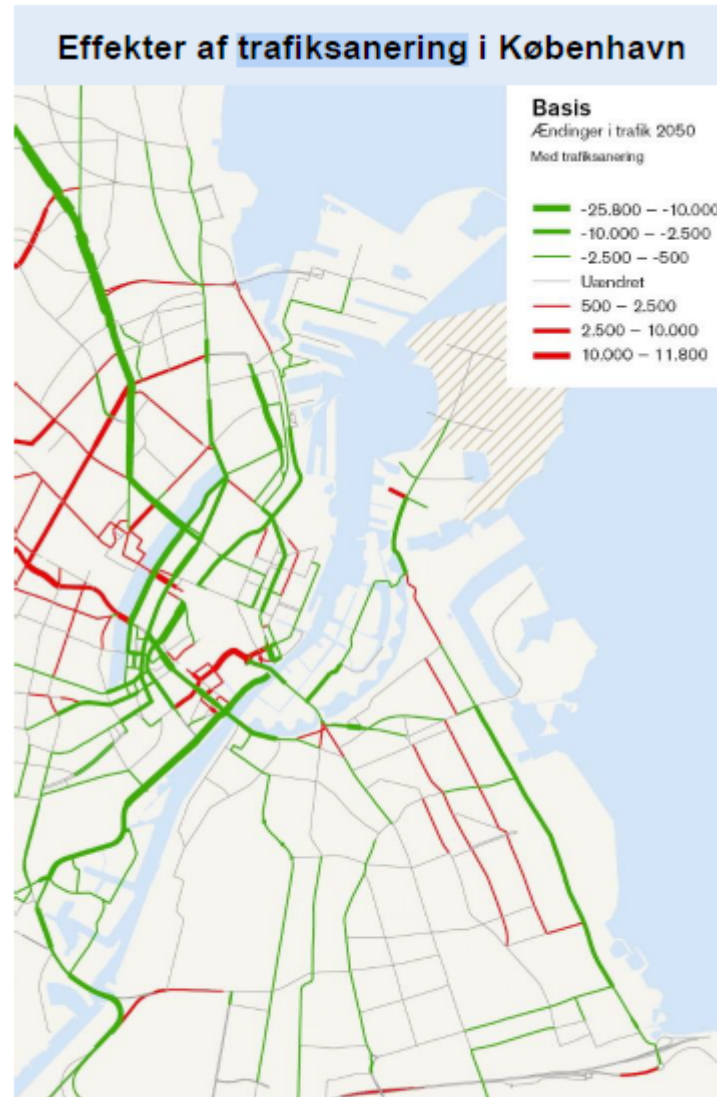
Fig 3.28 Veje i Kbh. som får mere eller mindre trafik som følge af gennemførelse af trafiksanering uden Østlig Ringvej.
